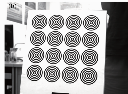
图 4 两台摄像机拍摄同一位置靶标的图像。(a)左摄像机拍摄图像;(b)右摄像机拍摄图像
