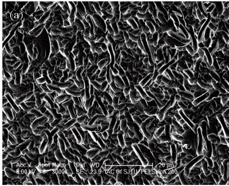
图 4 改良后 \text{HF-HNO}_3\text{-H}_2\text{O} 腐蚀液刻蚀的多晶硅表面 SEM
