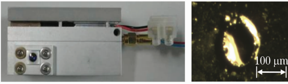
图4 半导体激光器实物与打靶的烧蚀坑照片
