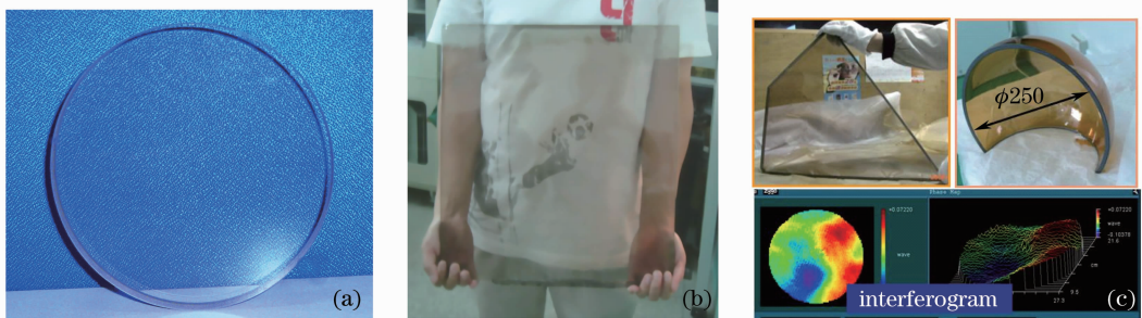
图 3 中科院上海光机所研制的大尺寸红外玻璃。(a) FAT 玻璃(约 \phi 250 \text{ mm} );(b) FGe 玻璃(约 500 \text{ mm} \times 450 \text{ mm} );(c) FGA 玻璃及光学均匀性干涉图( \Delta n = 8.7 \times 10^{-6} )
