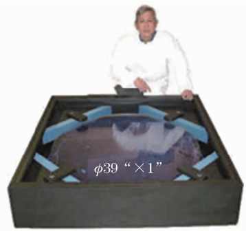
图 1 Infrared Fiber System 公司研制的大尺寸氟磷酸盐玻璃(约 1 m)
