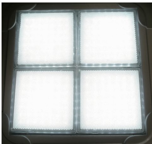
图 12 基于微结构散光板的 LED 面光源
