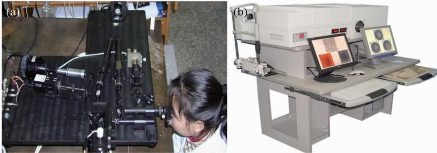
图 12 两代自适应眼底相机系统照片
