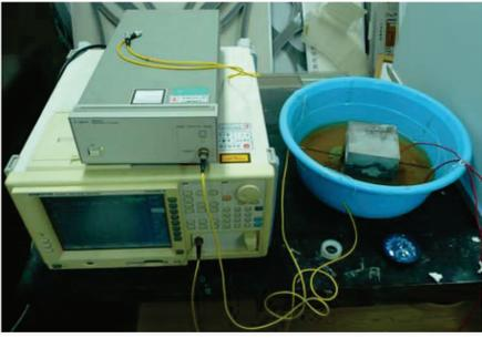
图4 钢筋锈蚀传感实验装置图
