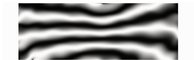
图 16 离面位移分量( w 场)的条纹图
