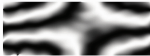
图 14 面内位移水平分量( u 场)条纹图 Fig. 14 In-plane displacement fringe of field u in horizontal direction
