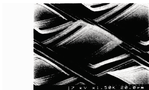
图 2 发生形变的微桥
