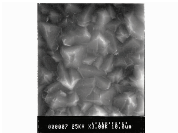
图 2 铈离子注入后样品表面的 SEM 照片(铈离子注入剂量为 1 \times 10^{16}/\text{cm}^2 )
