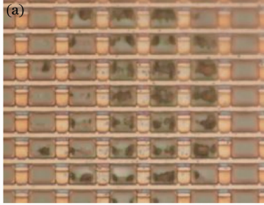
图 3 白色亮线破坏的 CCD 不同层损伤的微观形貌。(a)遮光钨,(b)衬底
