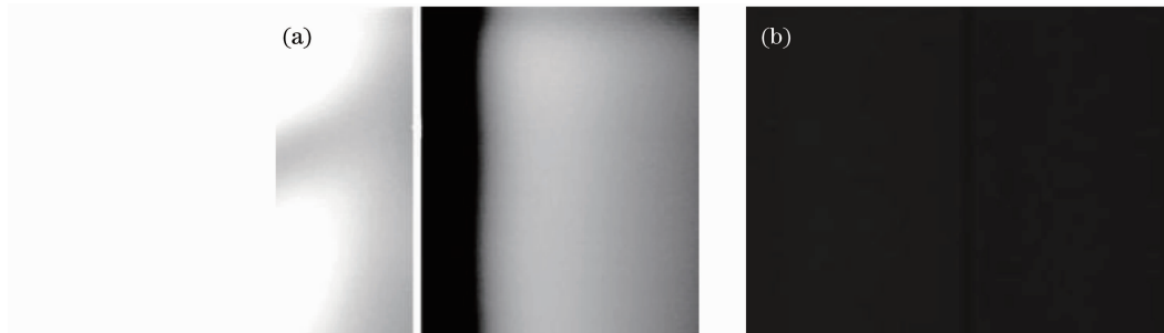
图 2 破坏 CCD 的输出图像。(a)不可恢复白色亮线,(b)失效 CCD 输出图像
