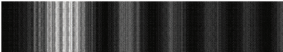
图 15 CCD 相机拍摄的一阶彩虹 Fig. 15 First-order rainbow captured by CCD camera
