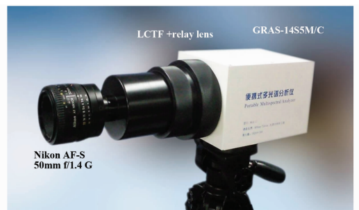
图 9 由 Nikon 镜头、LCTF、中继系统和工业相机组成的多光谱成像仪实物图
