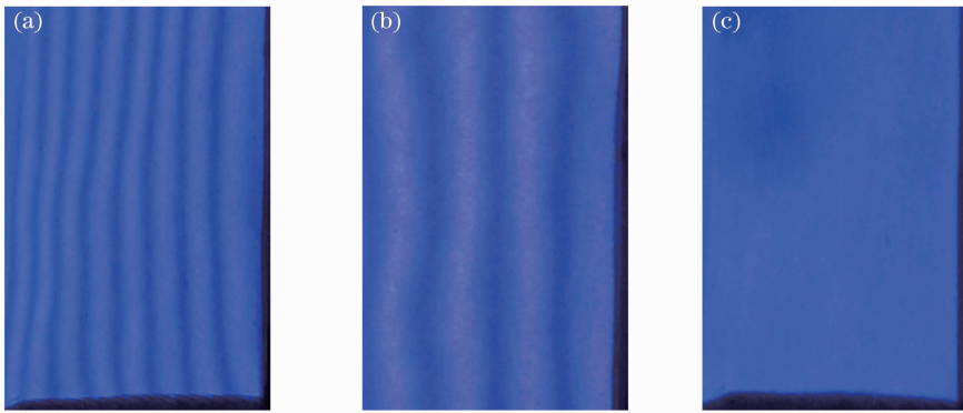
图 5 刻线密度调整中不同调整误差时莫尔条纹图
