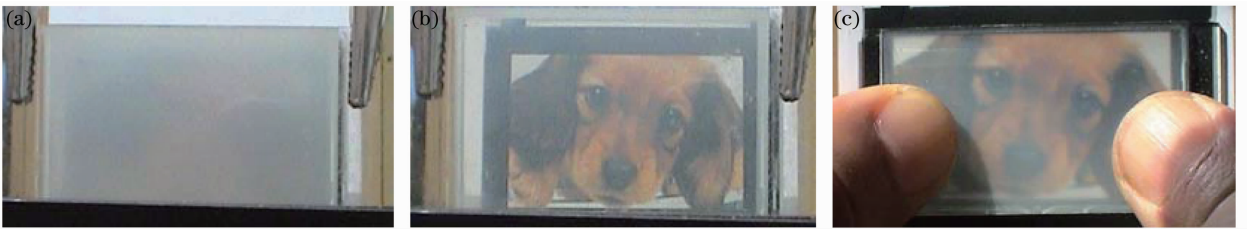
图 1 压光效应聚合物分散液晶样品照片。(a)散射态(雾度 H>90\% ), (b)施加电压的透明态(透射比 T>85\% ), (c)施加按压应力的透明态(透射比 T\approx 50\% )
