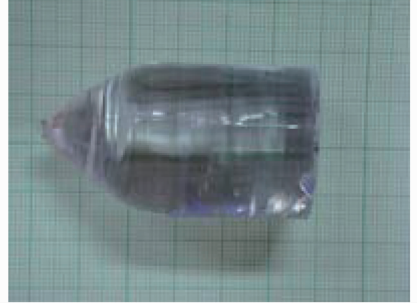
图 1 提拉法生长的 Tm 代 Y 原子数分数 2% 的 Tm:YLF 晶体
