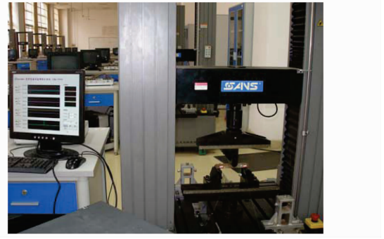
图 8 智能金属梁压弯实验图
