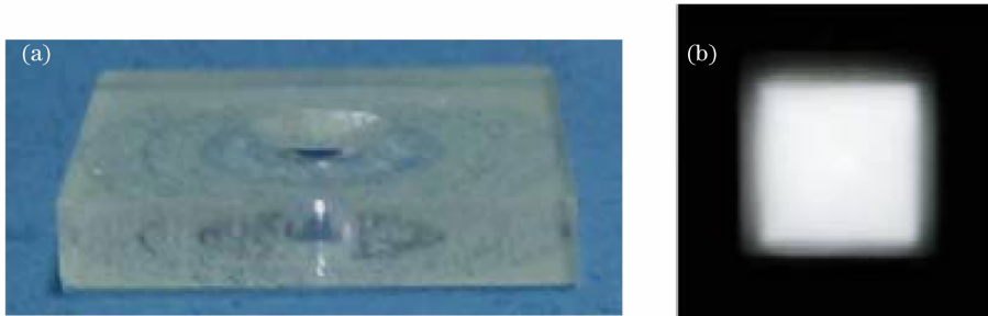
图 11 背光模块照明实验。(a) 导光板模块; (b) 照明结果
