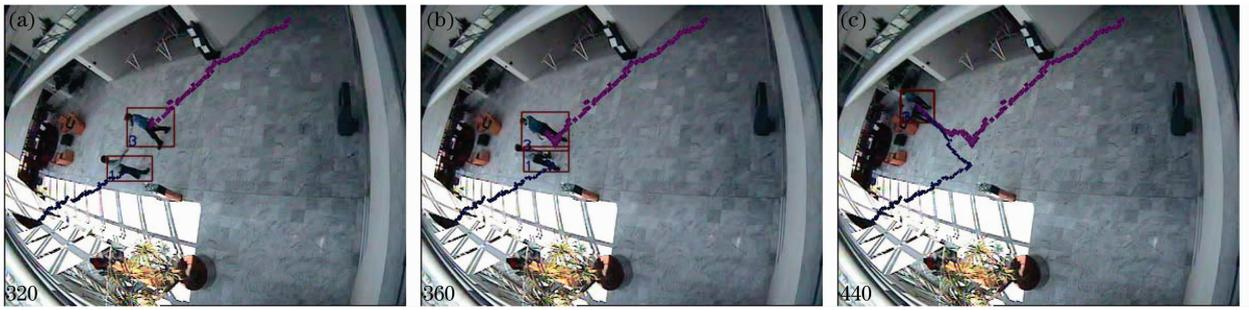
图 3 多目标合并跟踪结果。(a)两个目标相向运动,(b)两个目标相遇同向运动,(c)两个目标合并
