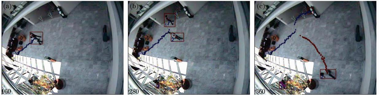
图 4 多目标分离跟踪结果。(a)两个目标同时同向运动,(b)两个目标运动方向改变,(c)两个目标分离
