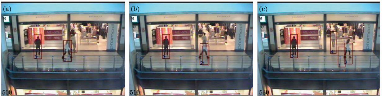
图 5 多目标冲突均值漂移跟踪结果。(a)3个目标独立运动,(b)目标 1 和 2 冲突,(c)目标 1 和 2 分离
