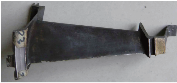
图 1 四级导向器分解叶片
