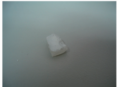
图 7 氧化的晶体表面的乳白色物质
