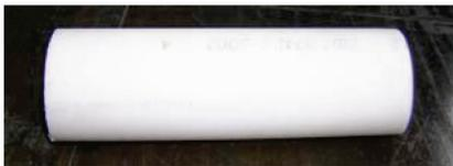
图 4 聚丙烯塑料管试件实物图
