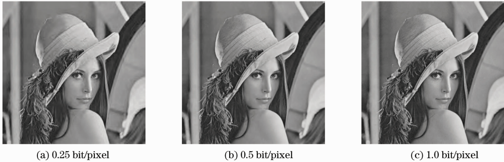
图 1 不同解码率下结合 OSS 框架与二叉树分割的 SPECK 算法对 Lena 的有损压缩效果
