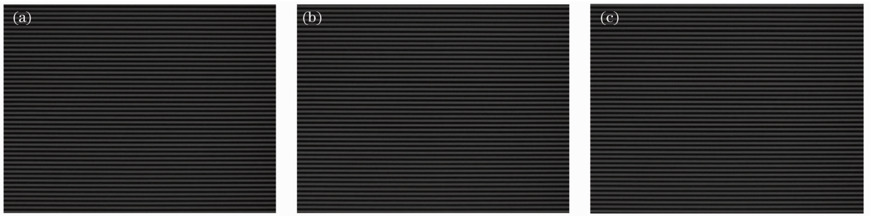
图 3 由 PMP 方法采集到的正弦条纹。(a)第一帧正弦条纹;(b)第二帧正弦条纹;(c)第三帧正弦条纹
