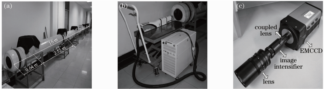
图 6 实验器材示意图。(a) 实验水道, (b) 激光器, (c) 选通接收器
