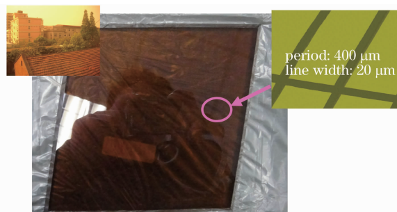
图 5 夹有金属网格的 FGa 红外复合材料
