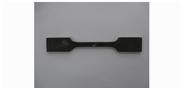
图 2 不同盲孔深度的 8 mm 疲劳试件
