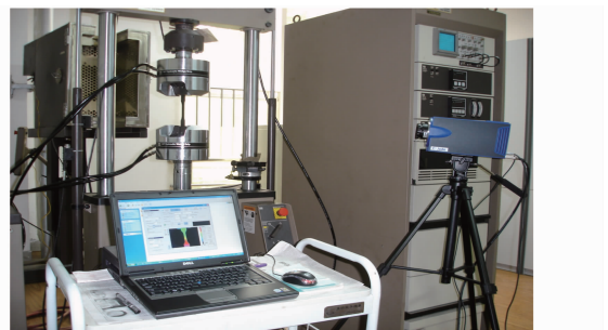
图9 疲劳试验中的锁相实时监测系统 Fig. 9 Lock-in real-time monitoring system for the fatigue test
