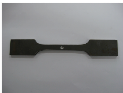
图 3 不同盲孔深度的 6 mm 疲劳试件
