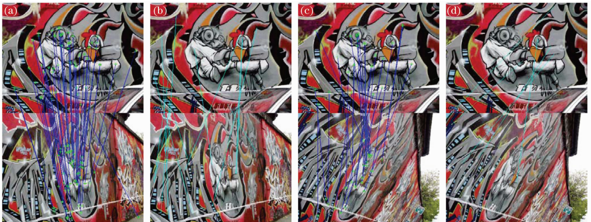
图 6 本算法和 SIFT 算法对 3D 视角差异的稳健性比较结果。(a) 本算法；(b) SIFT 算法；(c) 本算法；(d)SIFT 算法 Fig. 6 Comparison of 3D view point angle robustness between our method and SIFT. (a) Our method; (b) SIFT method; (c) our method; (d) SIFT method
