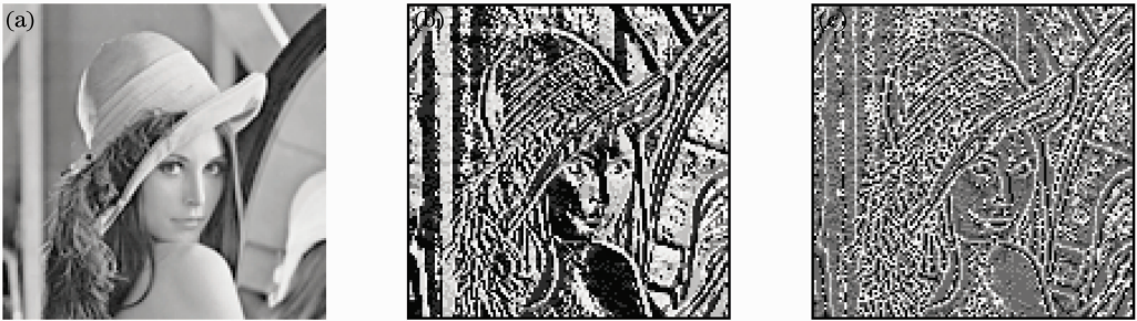
图 3 均匀模式与灰度不变性 LBP 比较示例。(a) 原图像; (b) 灰度不变性 LBP 结果图; (c) 均匀模式结果图
