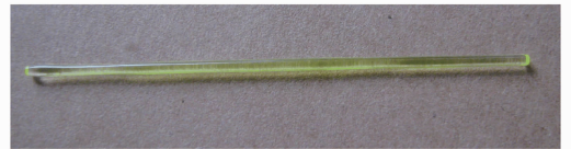
图 3 Ce^{3+} :YAG 单晶光纤
