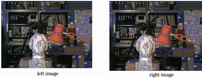
图 2 利用 L_5S_5 和 E_5E_5 模板组合分割得到的 Tsukuba 图纹理单一区域
