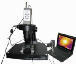
图1 光学微扫描显微热成像系统
