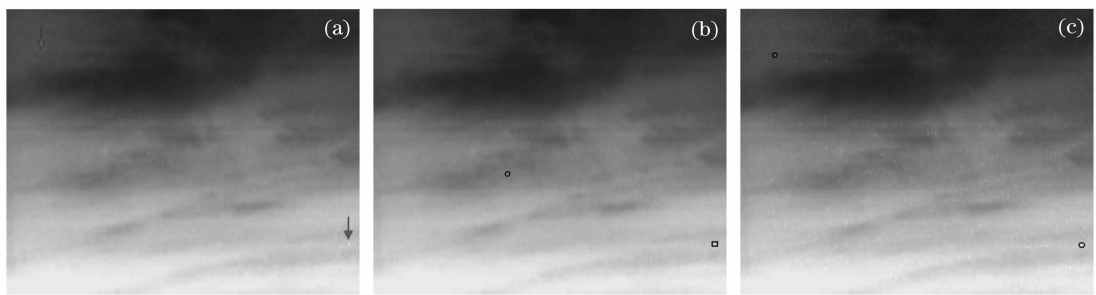
图 7 匹配滤波器设计对红外弱小目标检测性能的影响。(a) 原始图像;(b) 经典空间匹配滤波;(c) 优化设计空间匹配滤波
