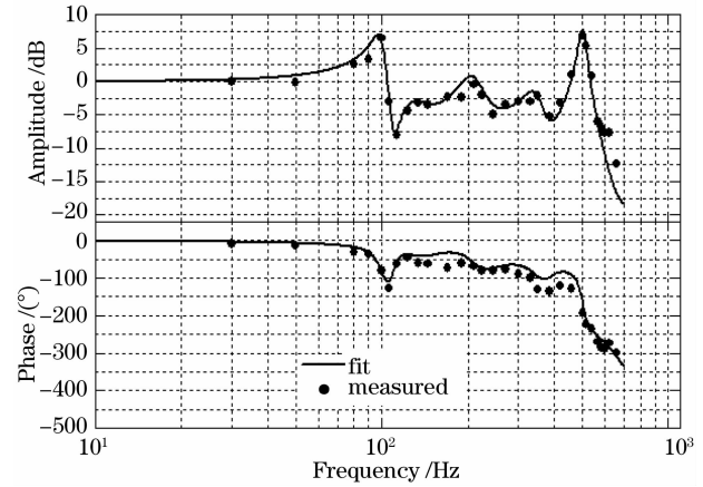
图 4 PZT 幅频和相频响应曲线
