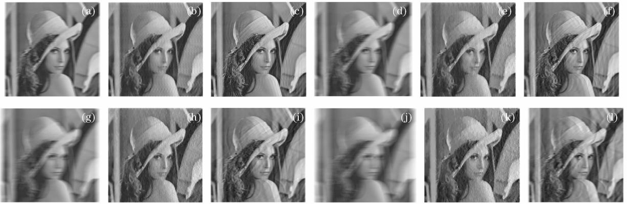
图 6 前景模糊图像恢复结果。(a),(d),(g),(j)分别为 N 等于 15,25,35,50 时的模糊图像；(b),(e),(h),(k)分别为 N=15,25,35,50 时本文算法的恢复结果；(c),(f),(i),(l)分别为 N=15,25,35,50 时维纳滤波的恢复结果
