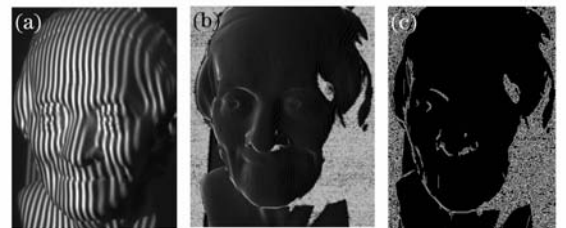
图3 相位质量图。(a)相移编码图,(b)质量图未锐化,(c)锐化残差质量图
