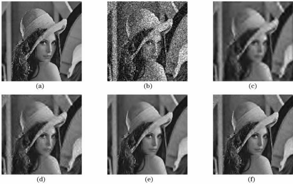
图 2 Lena 图像的去噪效果。(a) 原始图像; (b) 含噪图像; (c) Contourlet 软阈值去噪; (d) Contourlet 硬阈值去噪; (e) 小波 NeighShrink 去噪; (f) 本文算法
