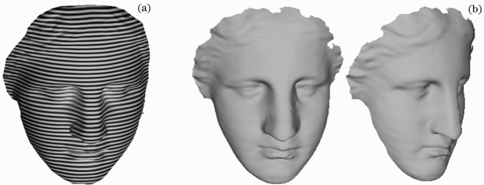
图 6 复杂面形测量结果。(a)变形光栅条纹图;(b)不同视角的三维网格渲染图
