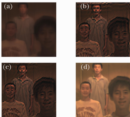
图 9 实际波前编码系统图像恢复结果。(a) 实际系统所成的模糊中间像; (b) 维纳滤波恢复结果; (c) 经过边界处理的维纳滤波恢复结果; (d) 新算法恢复结果
