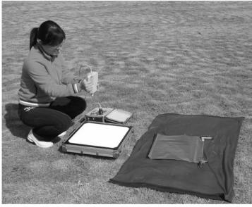
图 2 卫星相关材料细分光谱特性测量场景及实验材料样品
