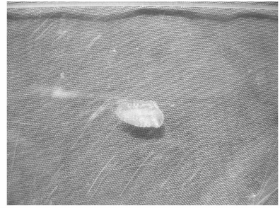
图 2 200 W 激光器的激光束在输出窗 20 mm 处的有机玻璃上烧蚀的图样
