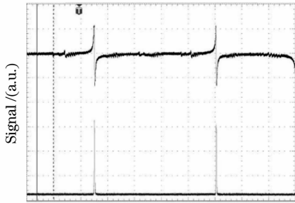
图 2 锁定电路的误差信号和共振信号
