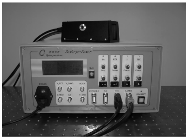
图 8 Hawkeye 系列外腔半导体激光器实物
