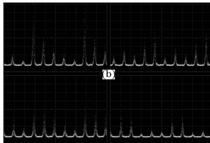
图6 未加入NALM环时锁模脉冲序列。(a)4倍频,(b)5倍频
