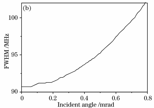
图 5 调谐角度对法布里-珀罗标准具半峰全宽的影响。(a) 不同入射角下的透射谱, (b) 透射谱半峰全宽与入射角的变化曲线
