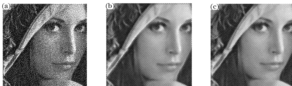
图 8 矩阵增益模型半调图像逆半调结果。(a)矩阵增益模型半调图,(b) Wavelet 逆半调图,(c) K-L 和中值插值金字塔逆半调图
