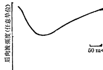
图2 用连续波读出光束得到的后向波(密度光栅)的时间特性
