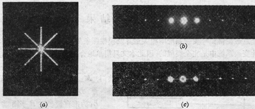
图2 (a) 用全息透镜获得的鉴别率板频谱; (b), (c) 用全息透镜和常规透镜获得的同一光栅频谱
