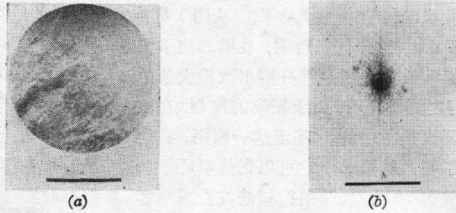
图 6 (a) 海洋波浪图像; (b) 放大的傅里叶变换图像 Fig. 6 (a) Input film; (b) Magnified Fourier transform
