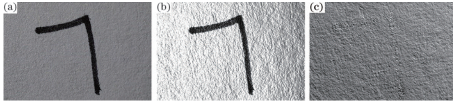
图 13 纤维笔(先横后竖)笔画的检验效果。(a)显微摄影;(b)镜面反光增强;(c)法线可视化
