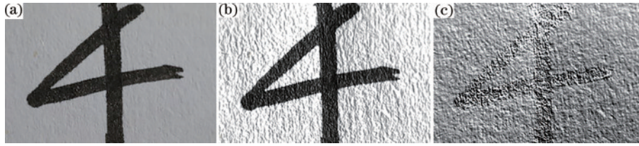
图 10 秀丽笔(先竖后横)笔画的检验效果。(a)显微摄影;(b)镜面反光增强;(c)法线可视化
