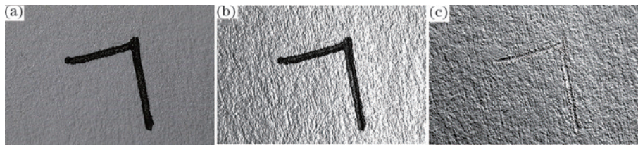
图 11 中性笔(先横后竖)笔画的检验效果。(a)显微摄影;(b)镜面反光增强;(c)法线可视化
