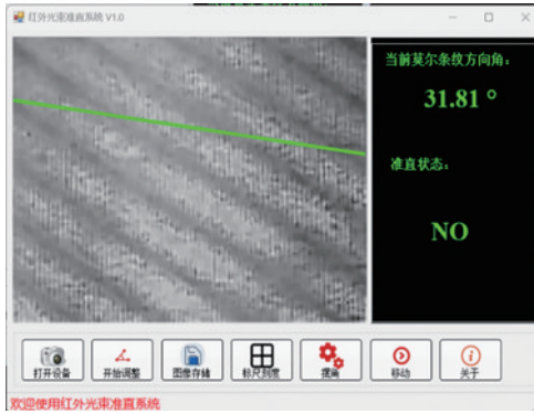
图 3 球面波照明时的莫尔条纹图形
